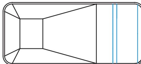
Escalier de bout pleine largeur avec rayon de 2' avec pont-soleil de largeur variable
